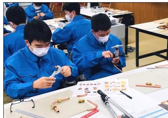
配管の切断とその先端を広げるフレア加工
