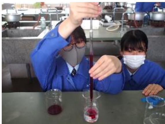
メスピペットを使って染料を採取します
