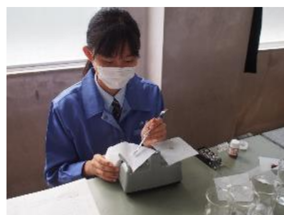
上皿天秤で染色助剤を計測しています
